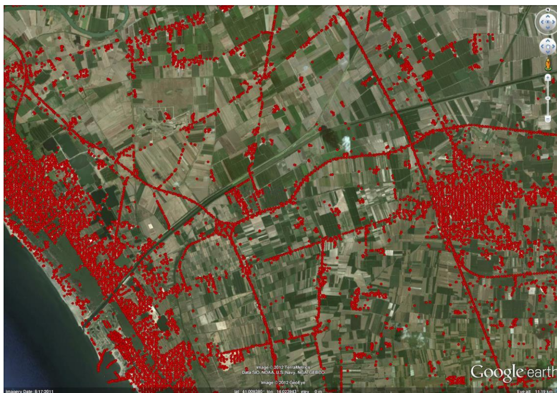
Figura 11 - Exemplo de distribuição espacial de PS (pontos vermelhos) sobreposto a uma imagem óptica. Os PS correspondem a áreas urbanas, ferrovias, rodovias, edifícios e infraestruturas. Não há pontos correspondentes em áreas cultivadas e com vegetação, ou corpos de água.
